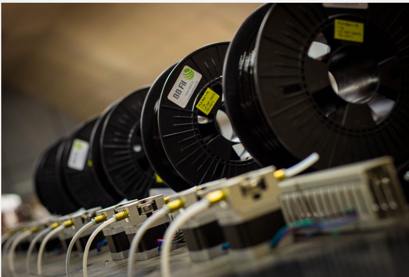
Détail des 10 extrudeurs de l'imprimante multi plateaux Tobeca 5X2
